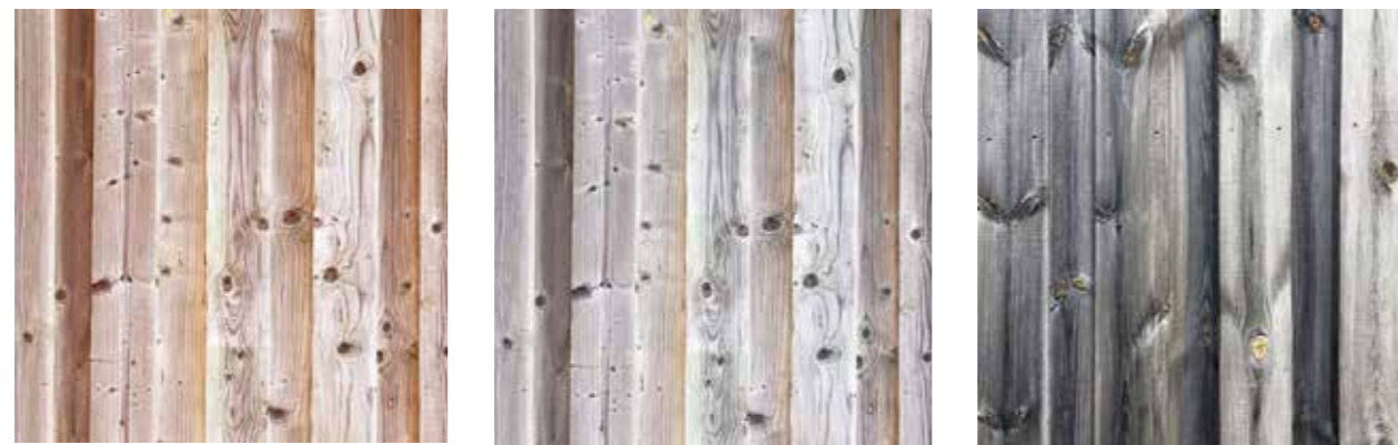
Séquences de vieillissement du bois
