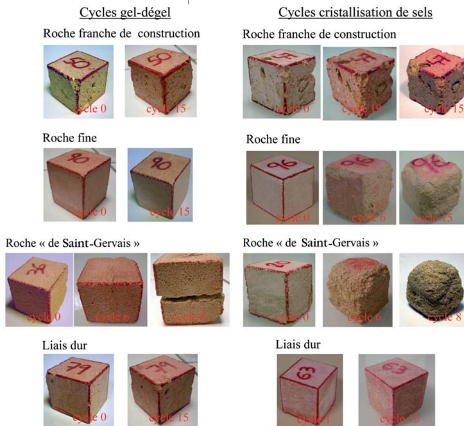
Fig. 5 - Résultats des tests d'altération artificielle accélérée sur différentes variétés du calcaire du lutétien.
