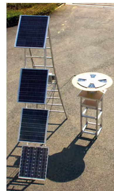
Le moteur solaire d'Eric Dychus et Alain Coty transforme directement l'énergie solaire en énergie mécanique.
